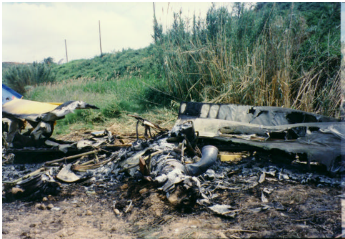
Foto 4.- Motor semienterrado; semiala izquierda; llanta rueda derecha; la hélice se desprendió antes.
