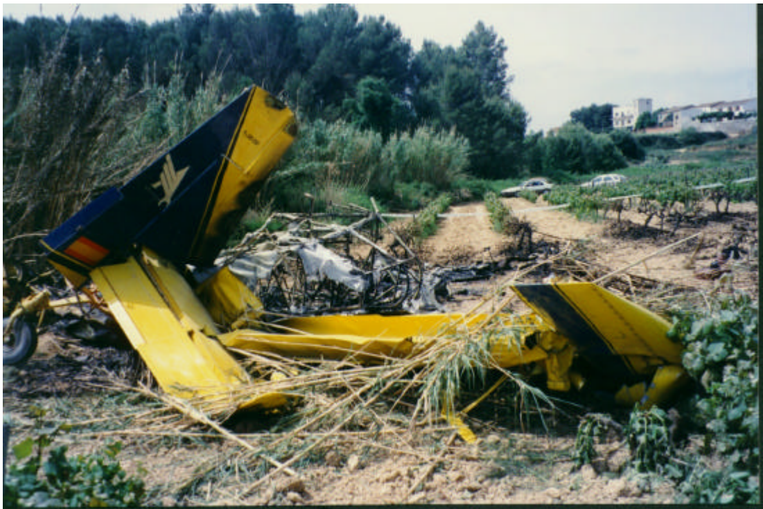
Foto 2.- Vista desde atrás; semiala derecha; fuselaje deformado y quemado; línea recta de llamaradas hacia las cepas; patín de cola intacto.
