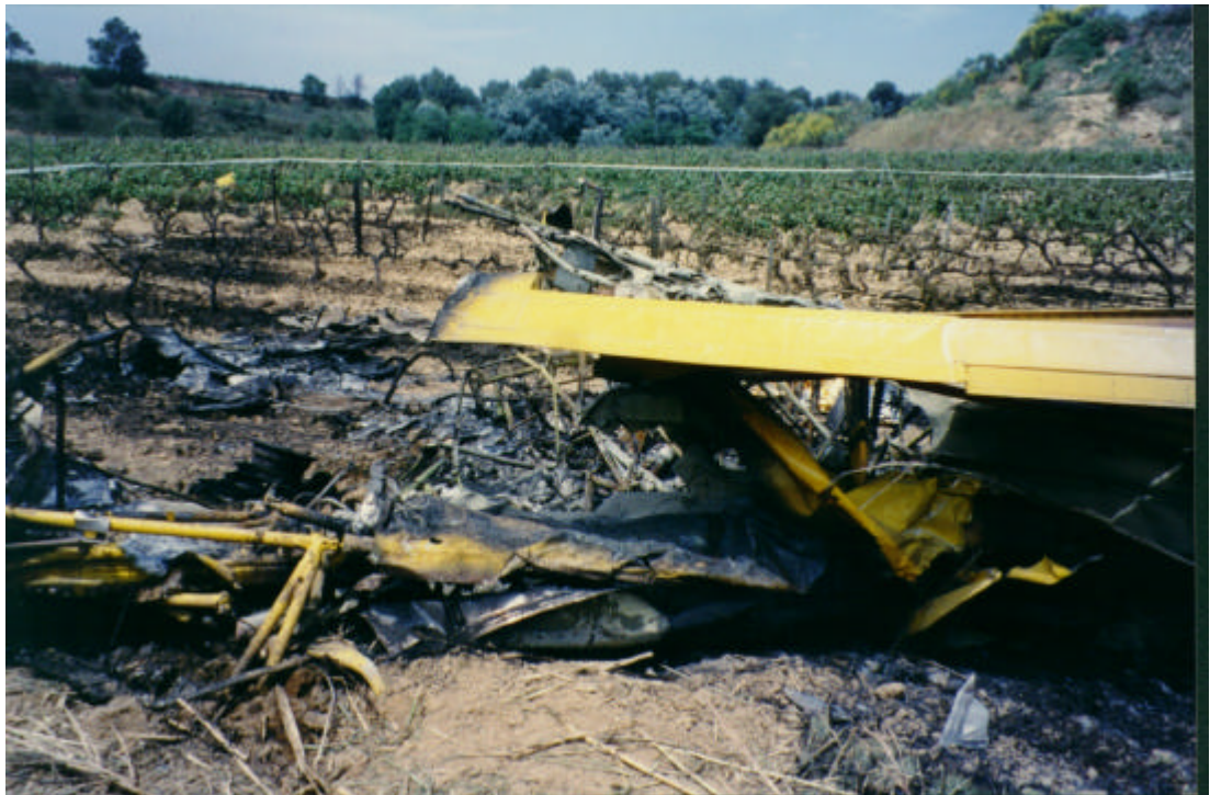
Foto 6.- Semiestabilizador horizontal izquierdo; llanta de la rueda derecha; línea recta de cepas quemadas,
