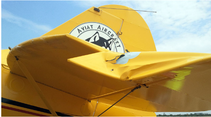
Figura 2. Daños en el timón de profundidad
