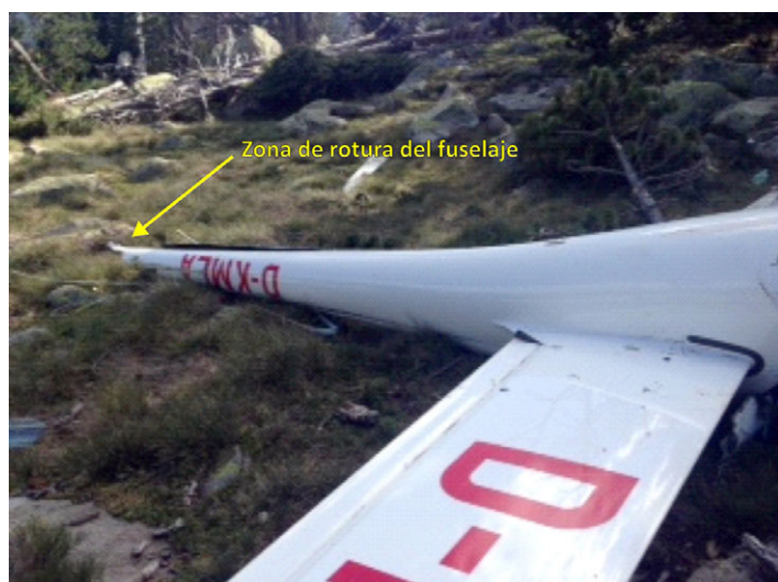
Figura 2. Fotografía de la parte final del fuselaje
