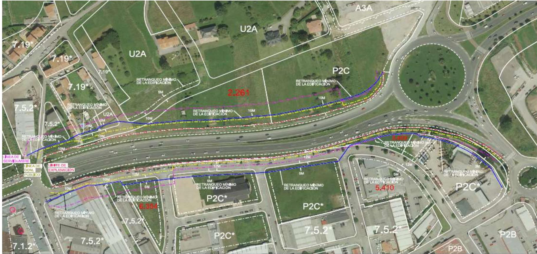
LÍNEA LÍMITE DE LA EDIFICACIÓN A AMBOS LADOS DEL TRAMO FINAL DE LA AUTOVÍA S-20 A PARTIR DE LA SALIDA DEL TÚNEL DE LA ALBERICIA, ESCALA; 1/1.500;
