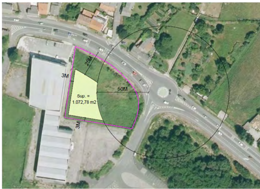
Fig. 7 Superficie entre líneas de edificación según Ley 37/2015
