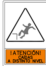
SEÑAL 4 RIESGO DE CAÍDA A DISTINTO NIVEL
