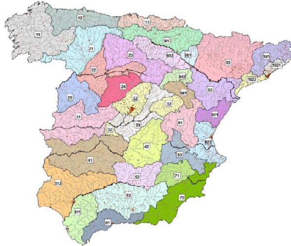
Figura 4.- Norma 5.2-IC (figura 2.9). Regiones consideradas para la caracterización del coeficiente corrector del umbral de escorrentía
