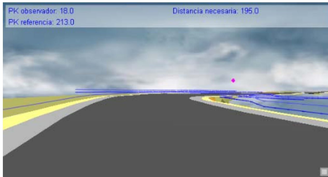
Observador situado en la calzada izquierda observando la referencia (el pórtico)
