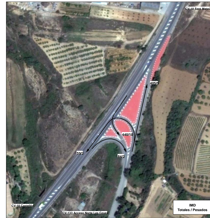
AF 7. Intersección de CV-10 con acceso Norte a Les Coves de Vinroma (CV-133) (IMD)
