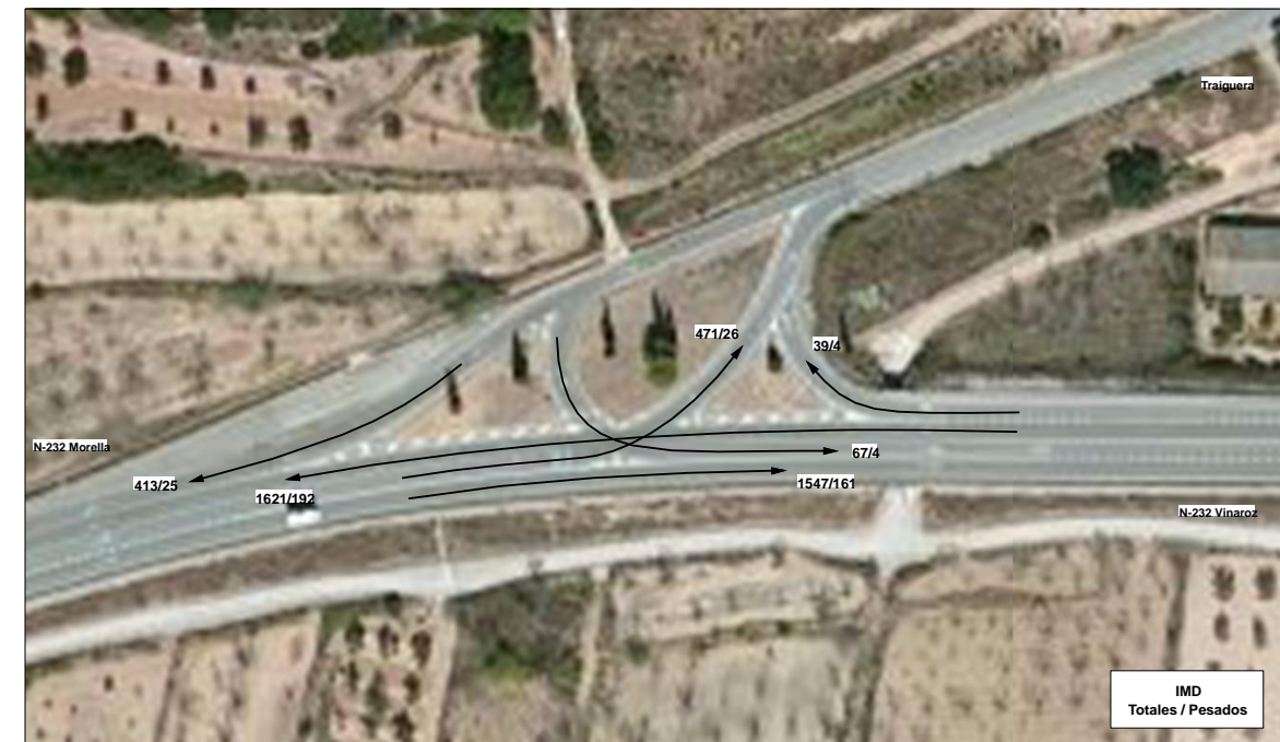
AF 15. Intersección de N-232 con acceso a Trigueros (IMD)
