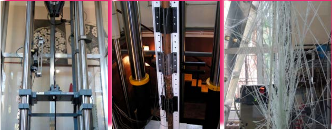
Ensayos mecánicos de aceros de construcción y de armaduras de polímeros reforzados con fibra de vidrio.
