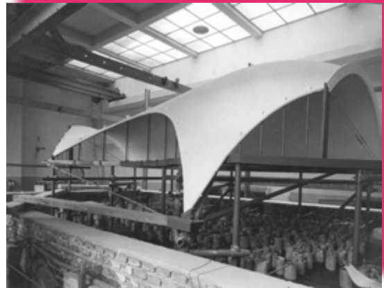
Ensayo del modelo de una cubierta para el Club Táchira de Caracas, proyecto de Eduardo Torroja (1957).
