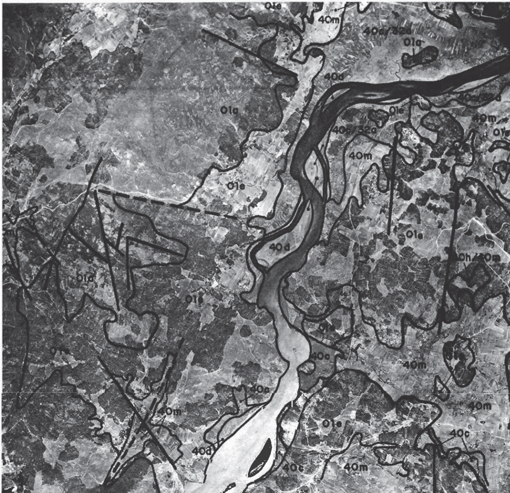
Fotografía aérea. Morfología del granito de dos micas. En el va- lle río Ulla. 01a: Granito de dos micas. 01b: Granito de dos mi- cas alterado a jabres poco potentes. 40m: Jabres. 32a: Sedi- mentos terciarios recubiertos de aluviones.
