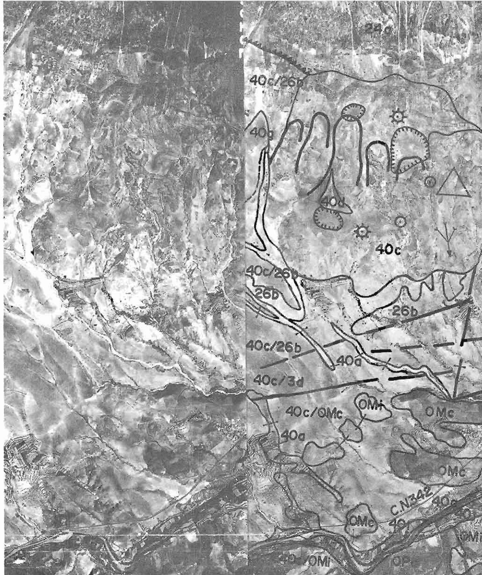
Foto 21.- Visión estereoscópica de los deslizamientos y hundimientos, a gran escala, en la ladera sur de la Sierra de María, sobre materiales cretácicos y/o terciarios. Obsérvense las "cicatrices" dejadas por la enorme masa deslizante y las terracetitas (o escalones) de superficie plana o cóncava, inclinada hacia la montaña, y que corresponden a retazos de la antigua superficie de la ladera. Hoja 974- 1.
