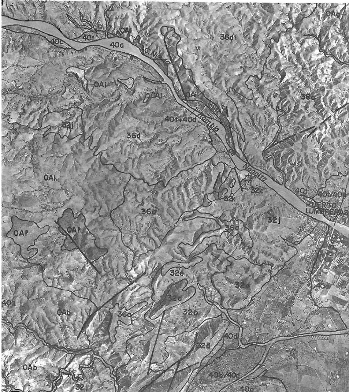
Foto 38.- Morfología de las principales formaciones terciarias (32b, 32d, 32e, 32j, 32k); pliocenas (36a 36d) y cuaternarias (40a, 40b, 40c, 40d) de Puerto Lumbreras. Cruza la zona el extenso y potente aluvial de la rambla de Nogalte. Obsérvese la dispar erosionabilidad de los tramos y su estabilidad en taludes naturales, puestas de manifiesto en el tipo y densidad de las redes de m drenaje respectivas, y los movimientos del terreno observados. Hoja 975-3.
