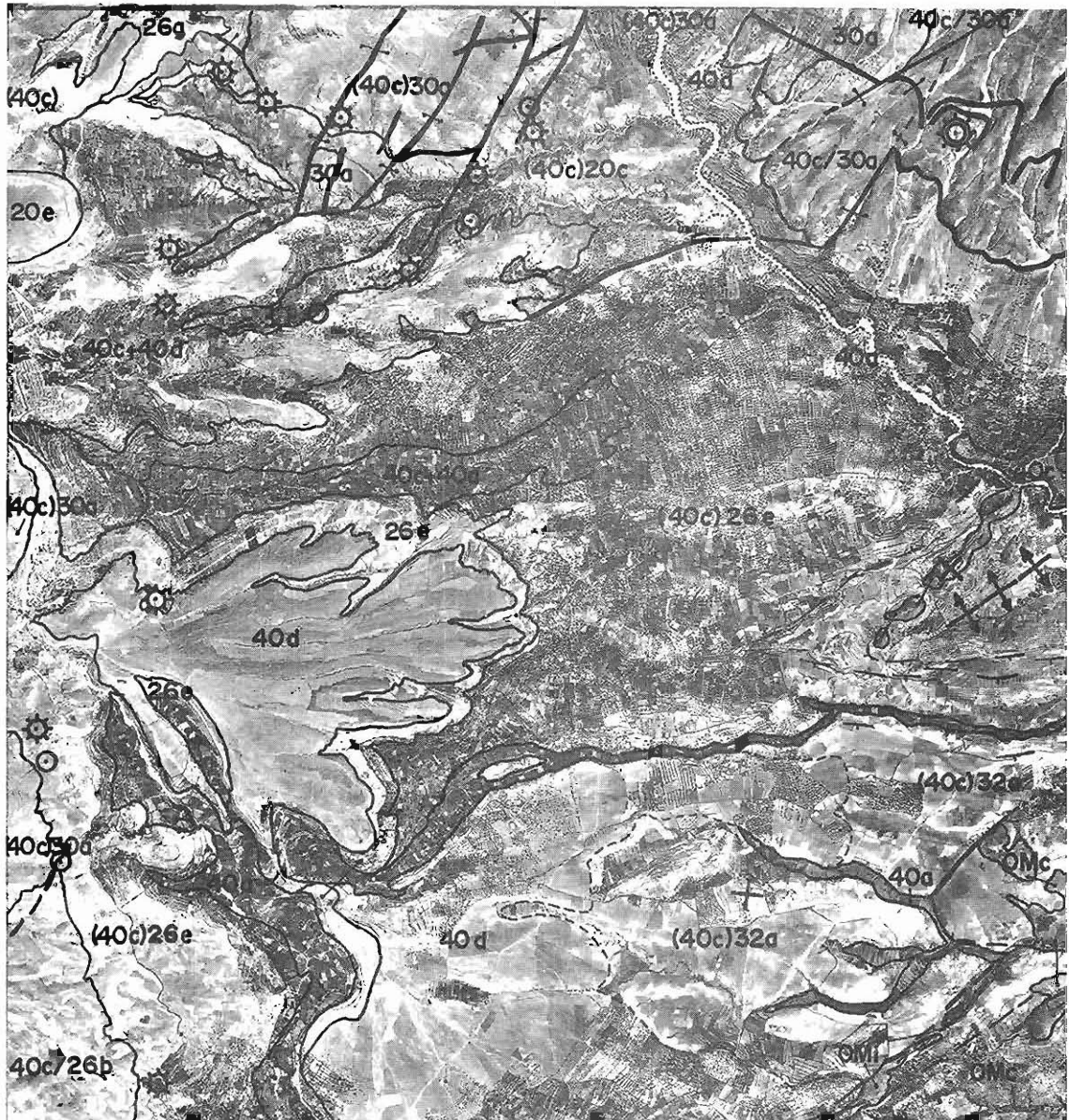
Foto 11.- Vista aérea del borde oriental de la Sierra de María y campos de Vélez-Rubio y Vélez-Blanco. Morfología quebrada en el valle del río Claro, y formaciones coluviales "colgadas" junto a la transversal de Vélez-Rubio a Vélez-Blanco. Obsérvense los desprendimientos y deslizamientos acaecidos en los materiales cretácico-terciarios (grupo 26e), apoyados sobre un yacente arcilloso-yesífero (20a) lábil y erosionable. Hojas 952-3 y 974-4.
