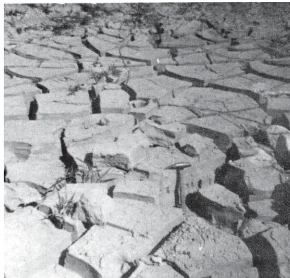
Geotecnia.- El principal problema del grupo lo constituye el drenaje, impedido en profundidad, y francamente malo en superficie con zonas encharcadas en los lugares deprimidos. Se producen hundimientos, frecuentemente, y las huellas de retracción, como testigos de entumecimiento temporal. son abundantes. Ripable. Problemas eventuales de agresividad y capacidad portante.
