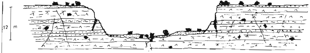
Fig. 8.— Corte esquemático de la gran torca situada a unos 50 m de la Cra local de Osa de la Vega a Belmonte en el paraje denominado Los Sumideros. A poca distancia de ella aparecen nuevos hundimientos y pequeñas torcas; todos ellos reconocen el mismo origen: hundimiento de las cavidades de disolución existentes en los yesos del grupo paleógeno 30n. Obsérvense numerosos bloques irregulares de sílex, sobre la superficie del terreno, segregados de la masa yesífera que los contiene.
