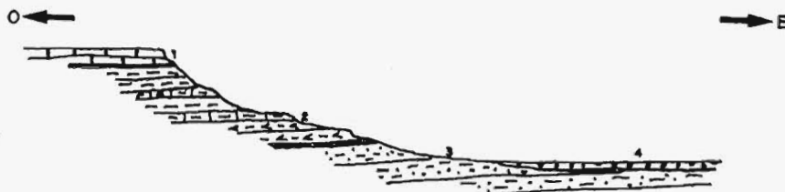
Fig. 2. Esquema geomorfológico de los escarpes miocenos 1) Altiplanicie del páramo (calizas) 2) Escarpe de la serie blanca (margas, calizas y margas yesíferas) 3) Escarpe de la serie rojiza (arcillas arenosas) 4) Terrazas (gravas con matriz arenosa)
