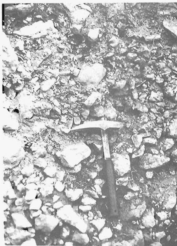
Foto 3.3.— Cantos de caliza con matriz areno-limosa del cono de deyección—coluvial de San Julián de Cerdanyola.
