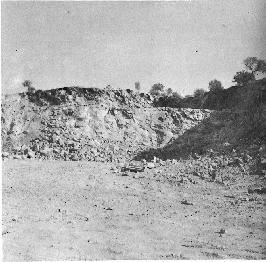
Foto 49.— Cantera de calizas y dolomías utilizada para la central nuclear de Almaraz, al sur del pueblo de Almaraz.
