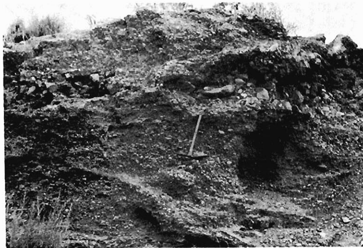
Fot. 41. Materiales detríticos, utilizables como préstamo, en el Barranco del Aguarico, al Norte de Sorbas.
