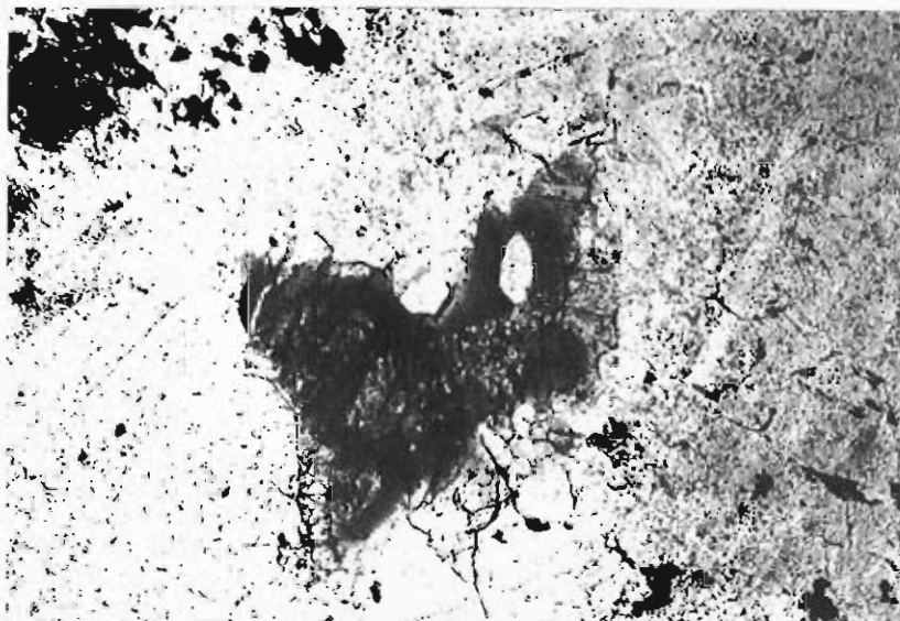
Foto 89.— Microfotografía de una serpentinita (LN x 10)
