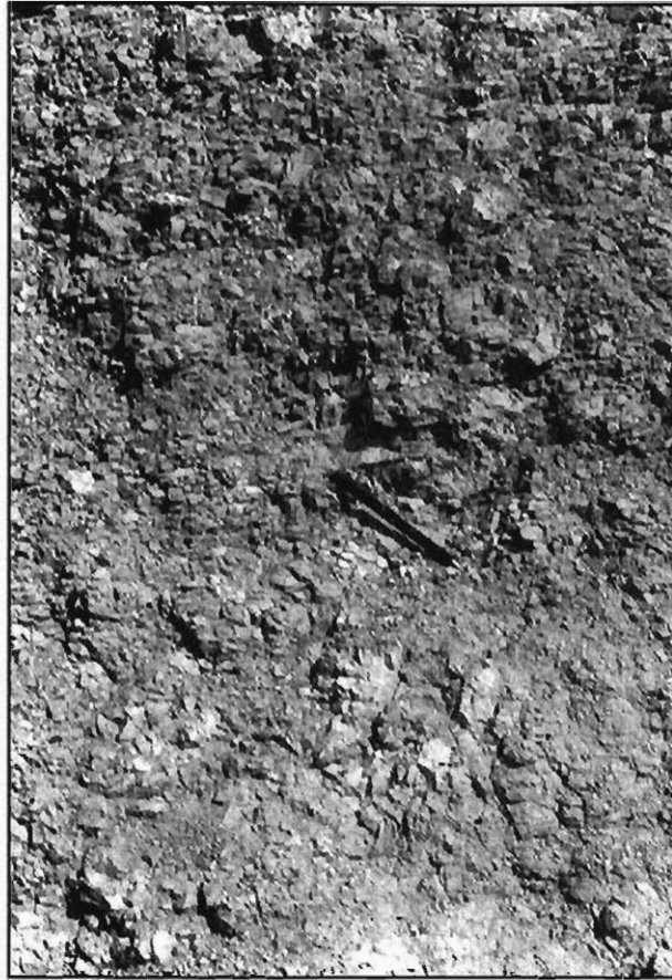
Figura 3.26.- Detalle de un nivel noduloso y cuarteado de las margas arenosas del grupo (322b), en un talud de la carretera N-431 en las inmediaciones de la población de Cartaya. (P.K. 675).
