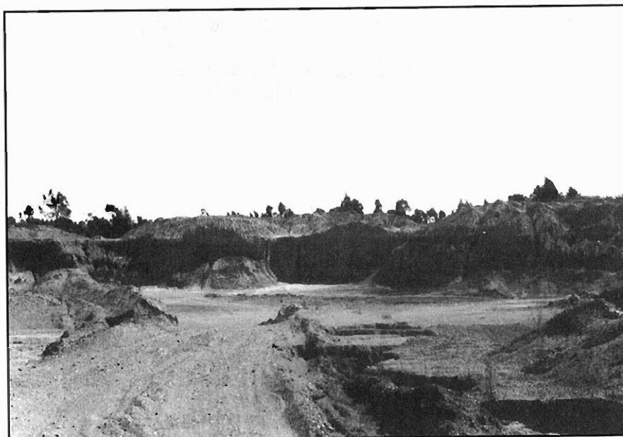
Figura 5.9.- Explotación del grupo (350), en una gravera situada al Sur del P.K. 694,200 de la carretera N-431. La parte superior de la gravera corresponde a los materiales del glacis (g3).
