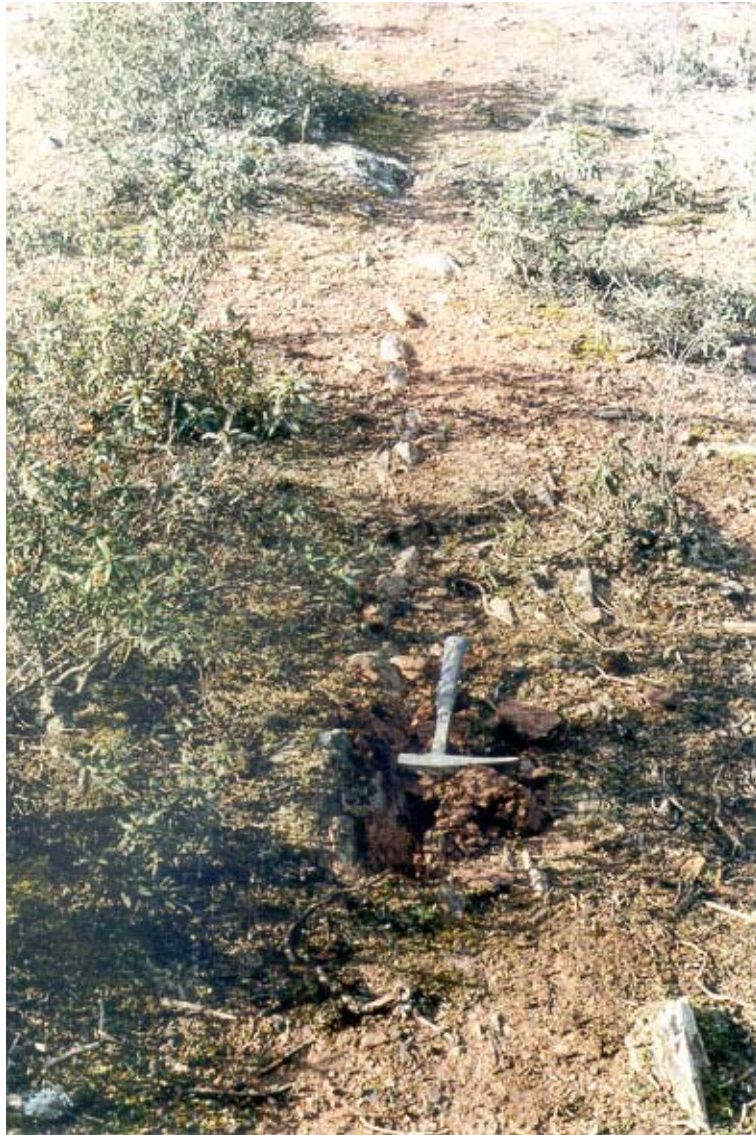
Figura 3.14. Detalle del eluvial limo-arcilloso rojizo que recubre a los esquistos del grupo (010b).
