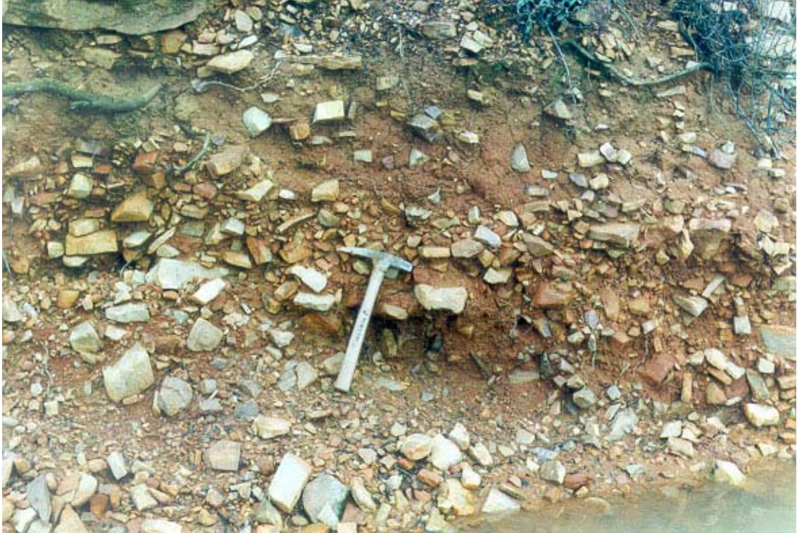
Figura 3.6. Detalle de los materiales coluviales del grupo (c), en el collado de la sierra que atraviesa la carretera de Bretocino a Foramontanos de Tábara (H:308/3).
