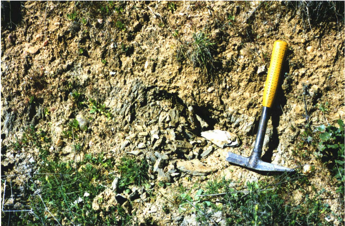
Figura 3.43. Aspecto de detalle de los esquistos del grupo (111b), en un afloramiento muy recubierto de las proximidades de la localidad de Carrascal de Velambélez (Hoja 452-3). Nótese la gran alteración de la roca.
