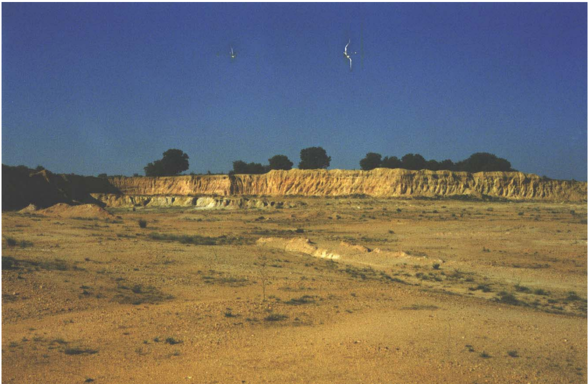
Figura 5.3. Arenero situado en las proximidades del p.k. 6,5 de la carretera C-527 (Hoja 397-4), en el que se han obtenido arenas y gravas de la formación (311a).
