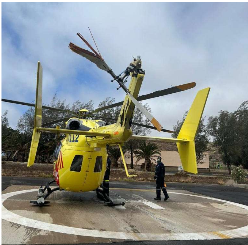
Fig nº 1.- Estado del rotor de cola y estabilizador vertical del helicóptero.
