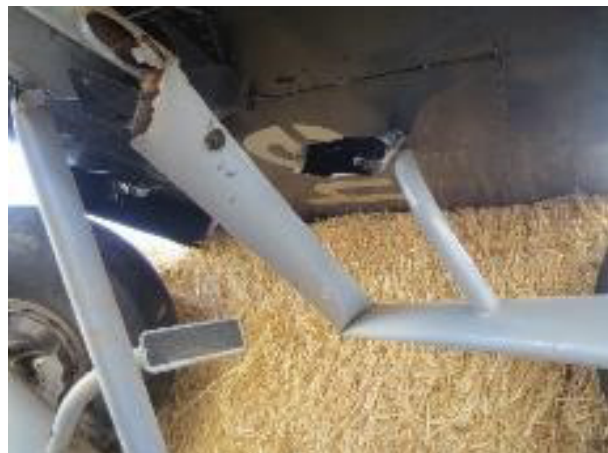
Fotografía 7. Daños en parte inferior del fuselaje
