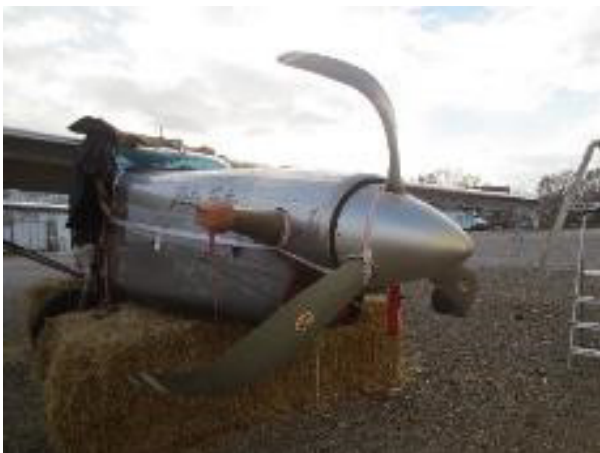
Fotografía 6. Deformación en hélice
