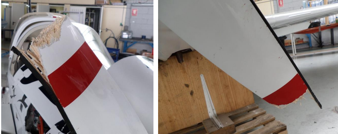
Figs. 8 y 9: Daños en ambas palas de la hélice
