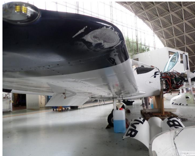
Fig. 10: Daños en la punta del semi plano derecho
