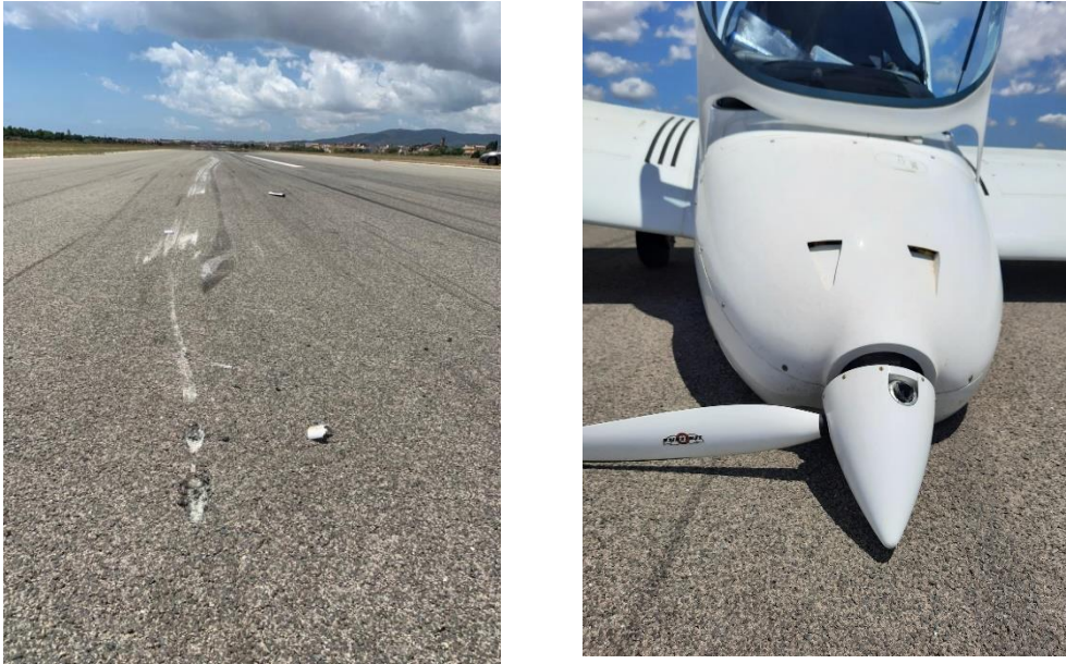
Fig.1: Marcas dejadas por la aeronave en la pista (izquierda) y aeronave tras el accidente (derecha).
