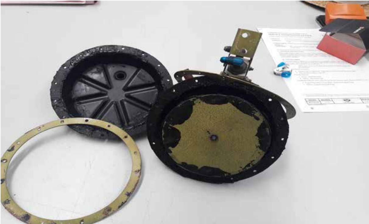
Fig. nº 9.- Despiece conjunto sensor de presión
