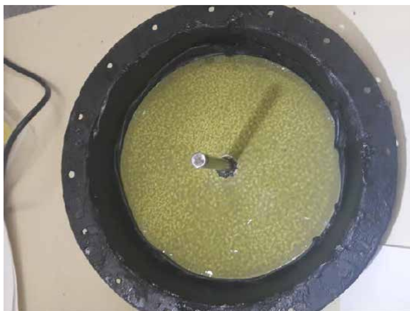
Fig. nº 8.- Vista de conjunto diafragma pegado a la carcasa
