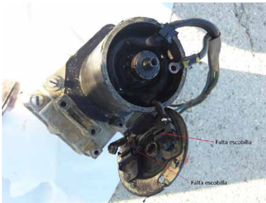
Fig. nº 6.- Estado de la bomba eléctrica
