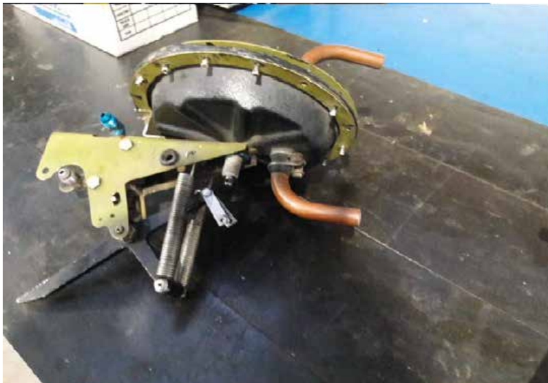
Fig. nº 7.- Aspecto exterior del mecanismo de sensor de presión
