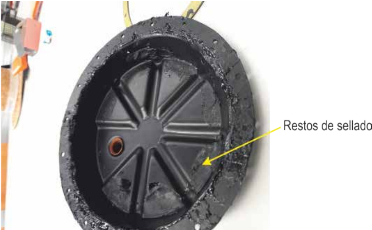
Fig. nº 11.- Semicarcasa donde estaba pegado el conjunto diafragma
