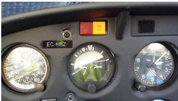
Fig. 2.- Luz ámbar de tren en tránsito y luz roja de tren inseguro
