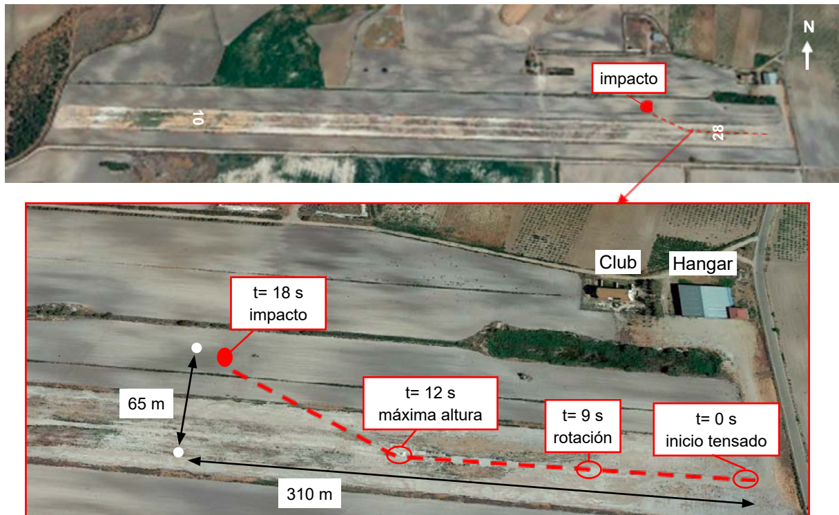
Figura 1. Trayectoria estimada de la aeronave y punto de impacto
