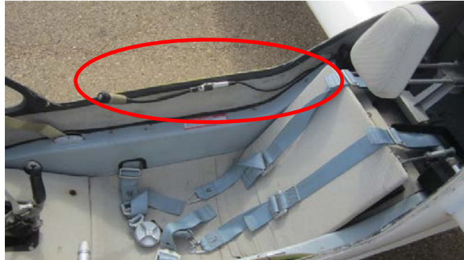
Figura 4. Tipo y ubicación del micrófono en la cabina EC-ESY
