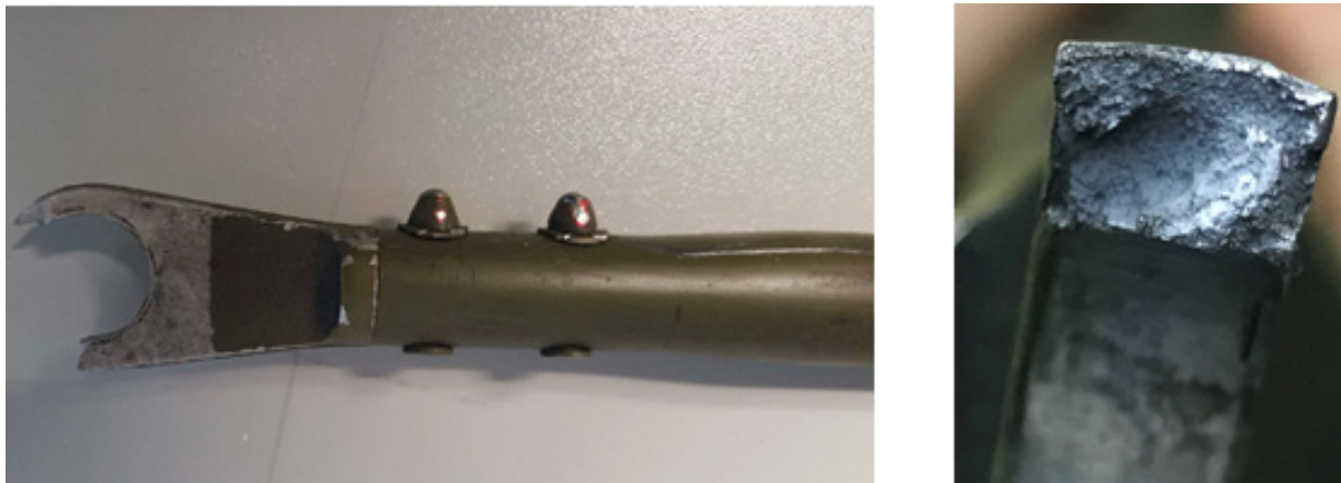
Ilustración 12: Detalle de la rotura del tubo de conducción de la pata delantera del tren de aterrizaje
