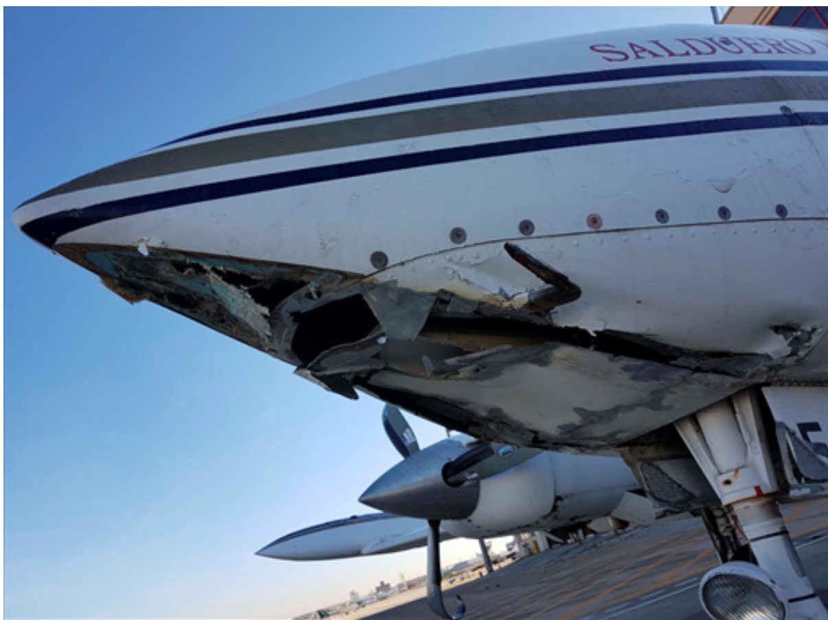
Ilustración 3: Detalle de los daños en la parte inferior del fuselaje y en una de las hélices
