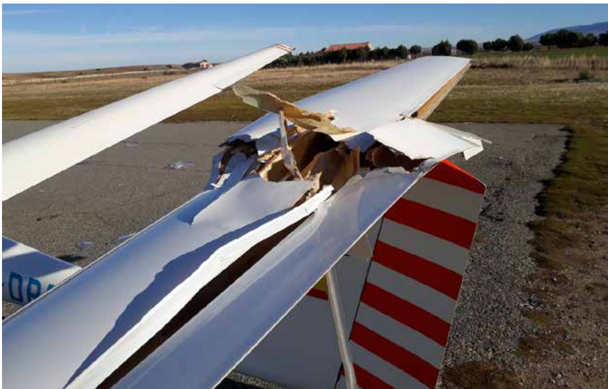
Figura nº 1.- Daños en el empenaje de cola, velero EC-DPE
