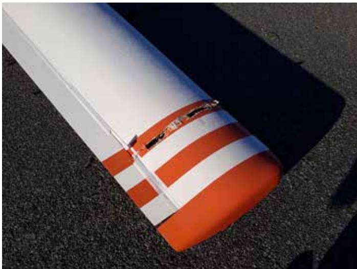
Figura nº 3.- Daño extremo de plano derecho EC-DPE
