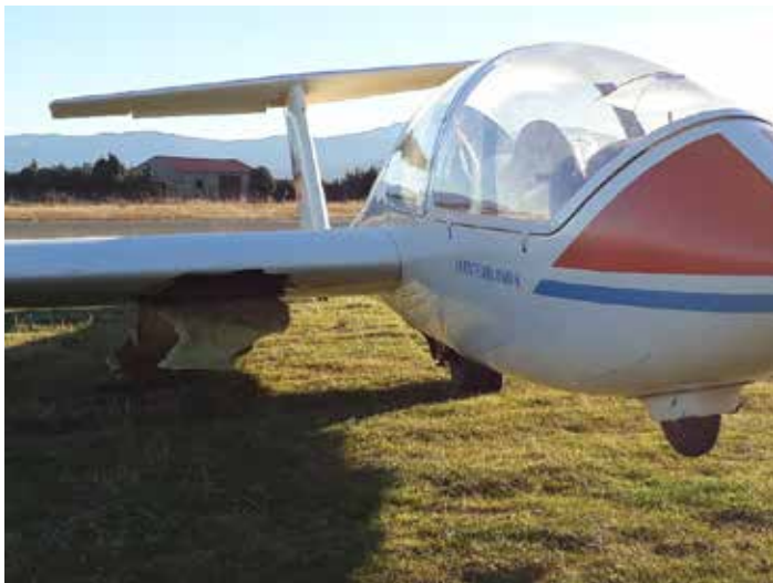
Figura nº 2.- Daño en el intradós plano derecho EC-DPB
