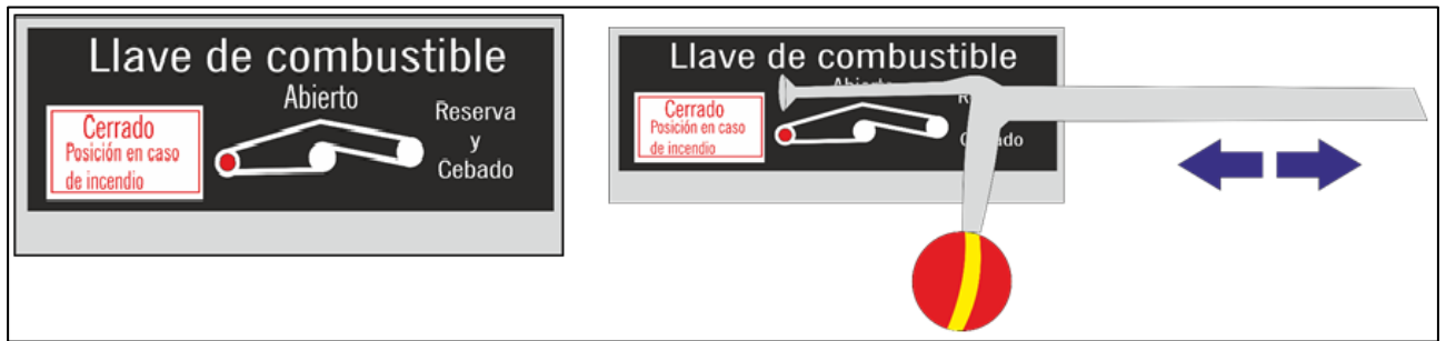
Fig. 3: Leyenda del cartel y detalle del mando llave de combustible en puesto trasero
