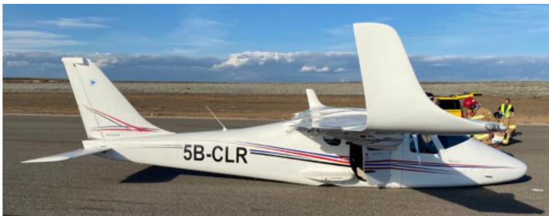
Ilustración 2: Estado en el que quedó la aeronave tras aterrizar sin extender el tren de aterrizaje
