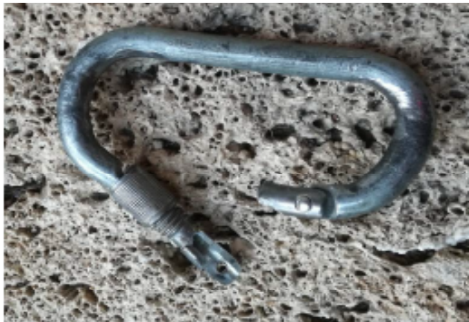
Figura nº 2.- Mosquetón de sujeción roto.
