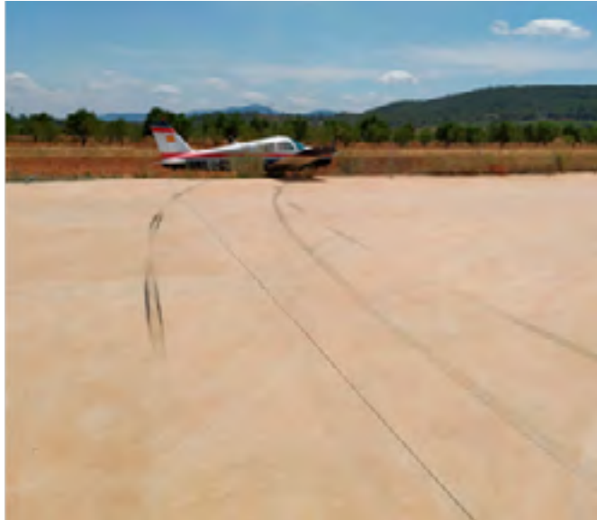
Figura 4. Huellas y posición final de la aeronave
