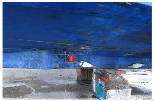
Figura 4. Imagen de la traca desprendida (imagen facilitada por ASTELEIROS TRIÑANES)
