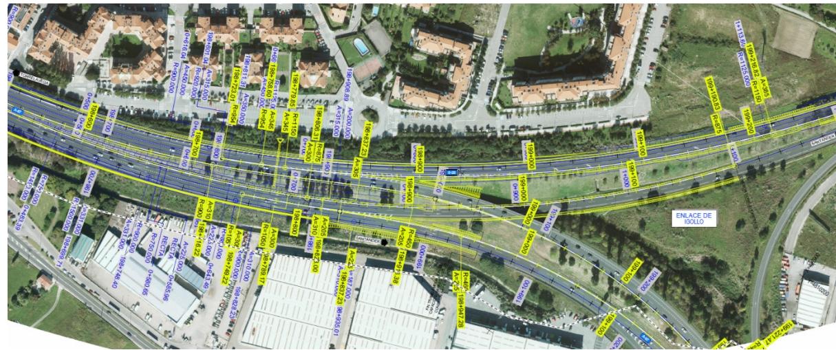
Trazado del tronco de la autovía A-67 del estudio informativo, en color azul, y el trazado propuesto, en color amarillo, entre el P.K. 198+600 y el P.K. 199+200.
