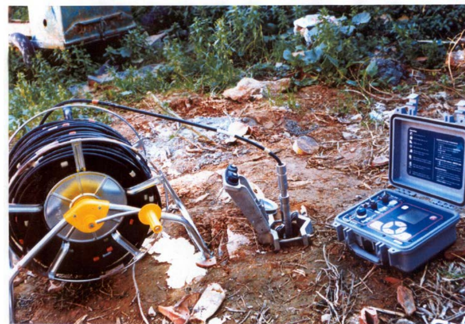
Figura 10.2.9.a.- Lectura de desplazamientos con un inclinómetro.
