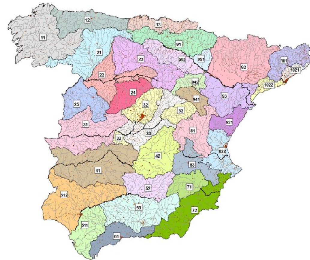
Imagen 8 – Regiones consideradas para la caracterización del coeficiente corrector del umbral de escorrentía (Figura 2.9 Instrucción 5.2. I.C.)
