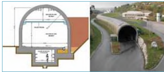
Figura 12: Sección del túnel de ensayos.
