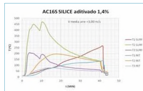
Figura 18b: Evolución de la temperatura superficial y en profundidad de la mezcla aditivada con el 1,4% con los sensores de temperaturas ubicados en las placas de mezcla bituminosa según el esquema de la Figura 13.
