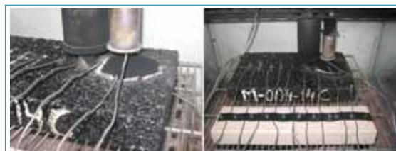
Figura 9: Muestra de AC16S sílice tras el ensayo aditivada al 1,0% (izda.) y con el 1,4% (dcha.)
