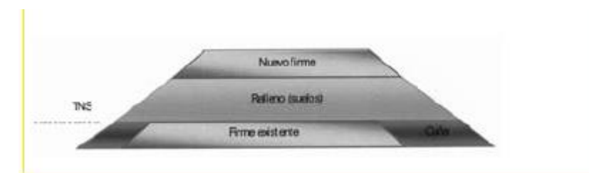
Esquema de incorporación de cuñas laterales al firme existente en acondicionamientos con elevación importante de la rasante
