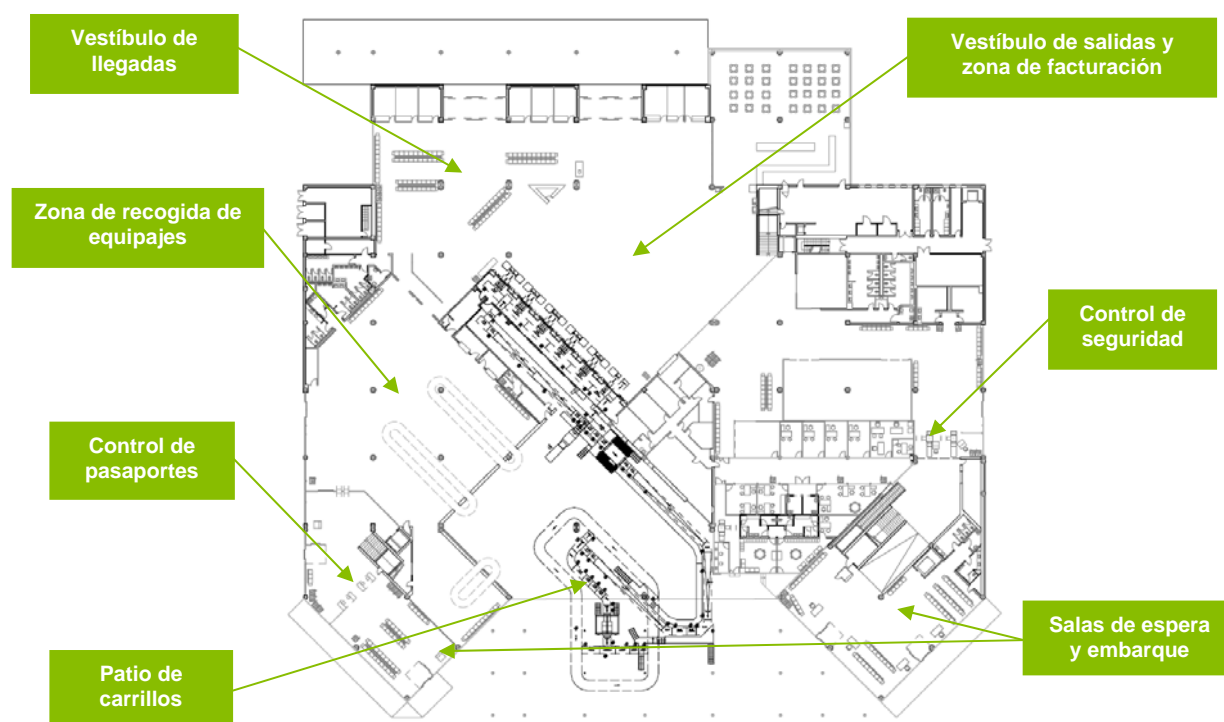
Ilustración 2.8.- Planta baja del Edificio Terminal de Pasajeros
