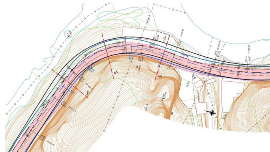
Trazados estudiados a la altura del P.K. 11+500. En color azul, el trazado con radio  $R=40$  metros. En color negro, el trazado con  $R=50\text{m}$ .
