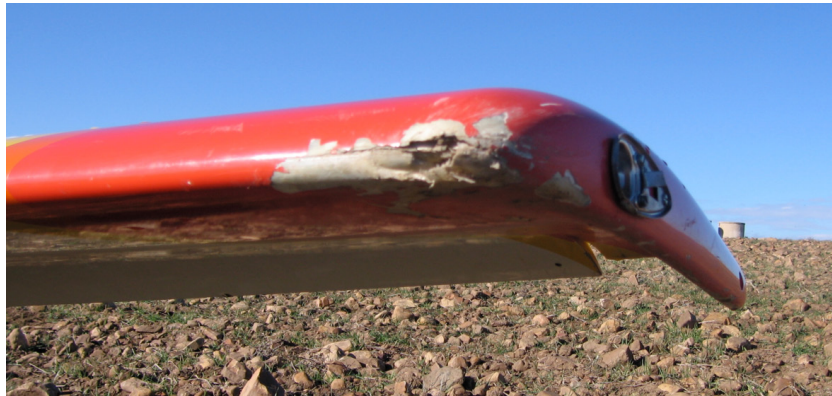
Figura 9. Daños en punta del plano izquierdo
