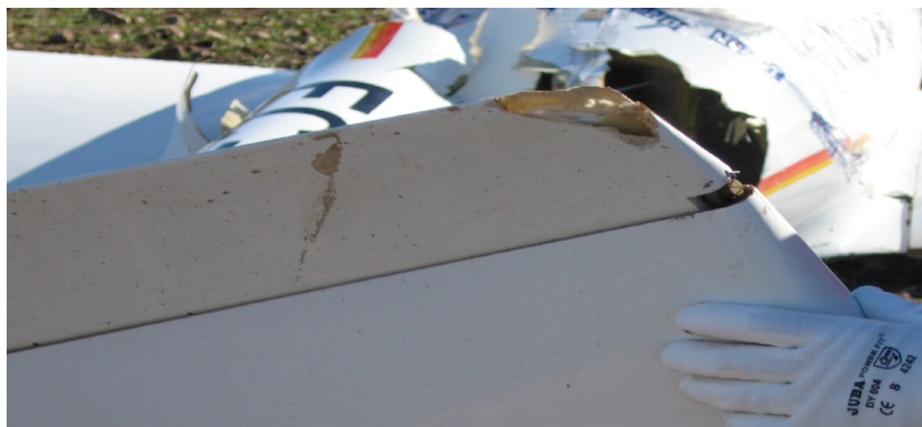
Figura 10. Daños en el extremo derecho del timón de profundidad
