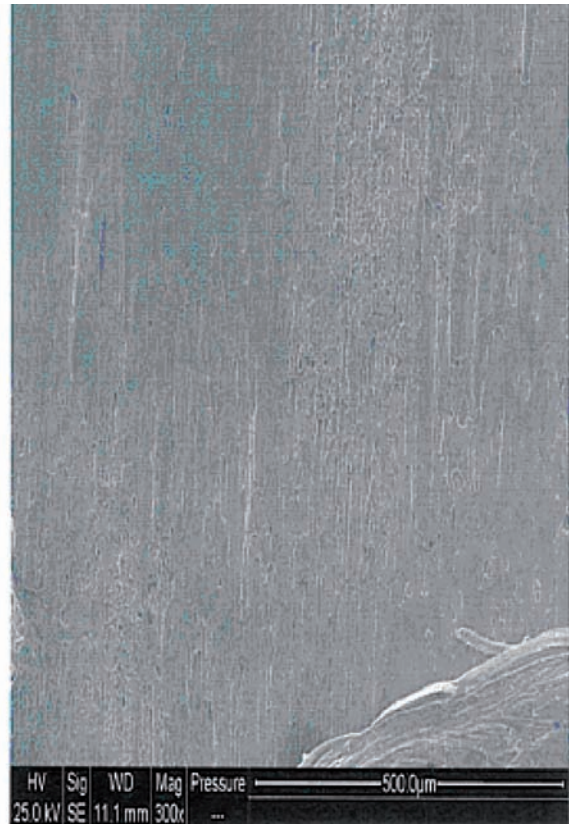
Micrografía 8. PERNO nº 2. La superficie de fractura presenta una textura lisa debida a una deformación microestructural muy intensa como consecuencia de una rotura por cizalla.
