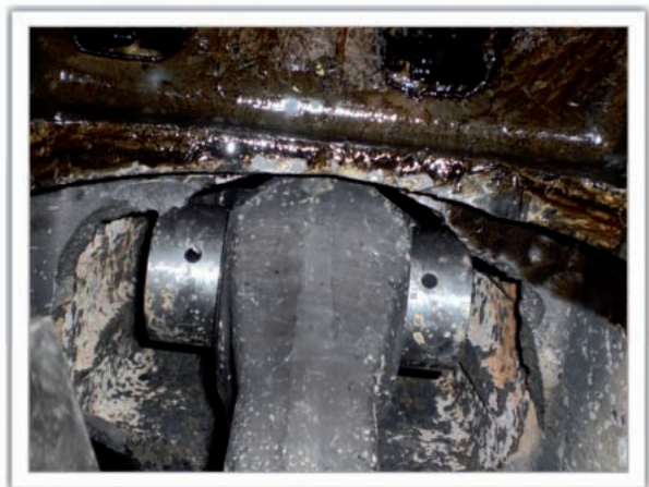
Figura 12. Vista interior de la biela en el cilindro
