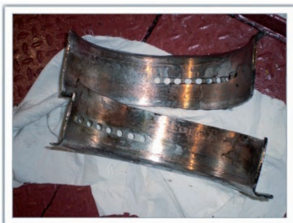
Figura 9. Aspecto de los cojinetes de cabeza de biela
