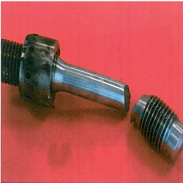
Figura 4. PERNO nº 2. Puede apreciarse la localización de la rotura.
