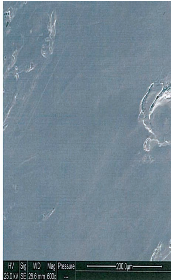
Micrografía 4. PERNO nº 1. La microscopía electrónica efectuada sobre la propia superficie de fractura permite apreciar unos caracteres muy lisos debido a la intensa deformación microestructural que se ha generado en la fractura por cizalla.
