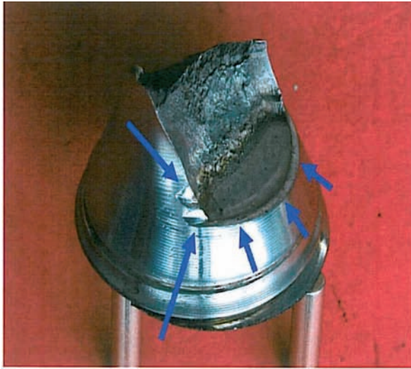
Figura 2. PERNO nº 1. Se señalan las zonas con marcas o indentaciones a partir de las cuales se genera la rotura. La rotura total de la pieza es el resultado de dos mecanismos de fallo, rotura primaria por mecanismos de cizalla y rotura final por sobreesfuerzo.
