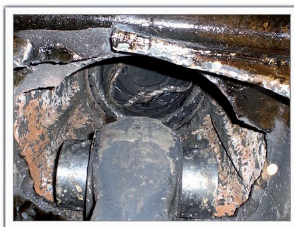
Figura 6. Extremo de la biela desprendida del émbolo
