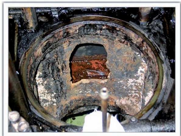
Figura 13. Rotura de cilindro
