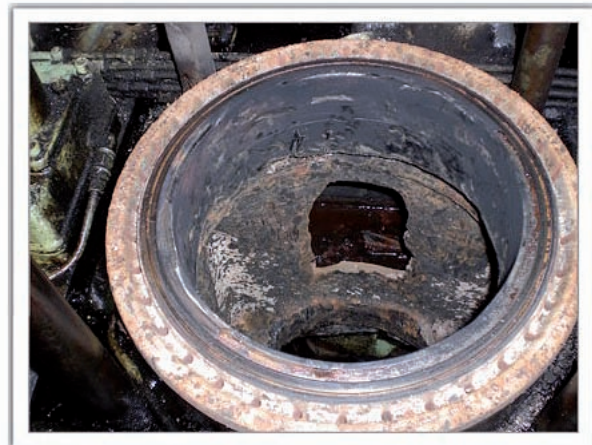
Figura 8. Aspecto interior del cilindro dañado
