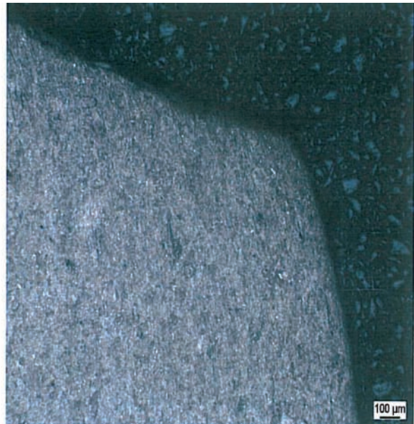
Micrografía 6. PERNO nº 2. Corresponde al inicio de la rotura, puede apreciarse la deformación debida al esfuerzo a cizalla.
