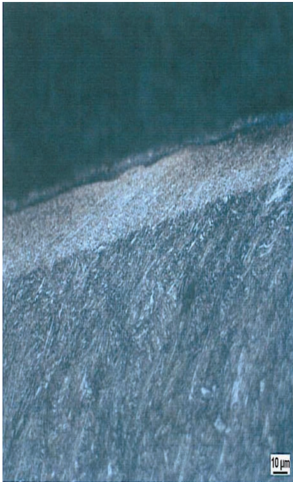
Micrografía 3. PERNO nº 1. Detalle de la intensa deformación estructural que se genera en la rotura, se llega a producir una capa blanca.
