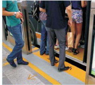
PLATAFORMA A NIVEL
