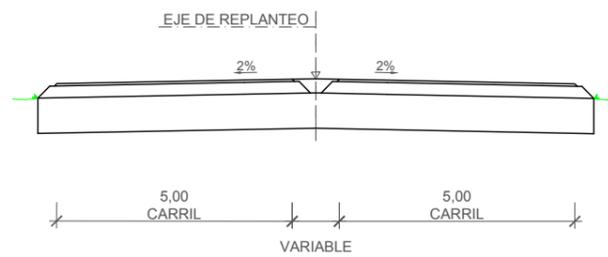
SECCIÓN TIPO RAMAL UNIDIRECCIONAL GL2-C9
