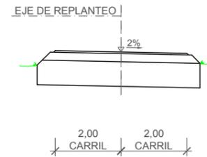
SECCIÓN TIPO CONEXIÓN C.S.1 - GL.2
