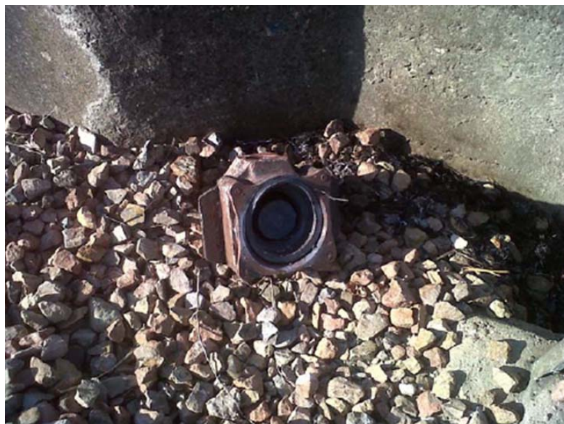
Caja de grasa desprendida, con mangueta en su interior (Fuente: Renfe Operadora)
