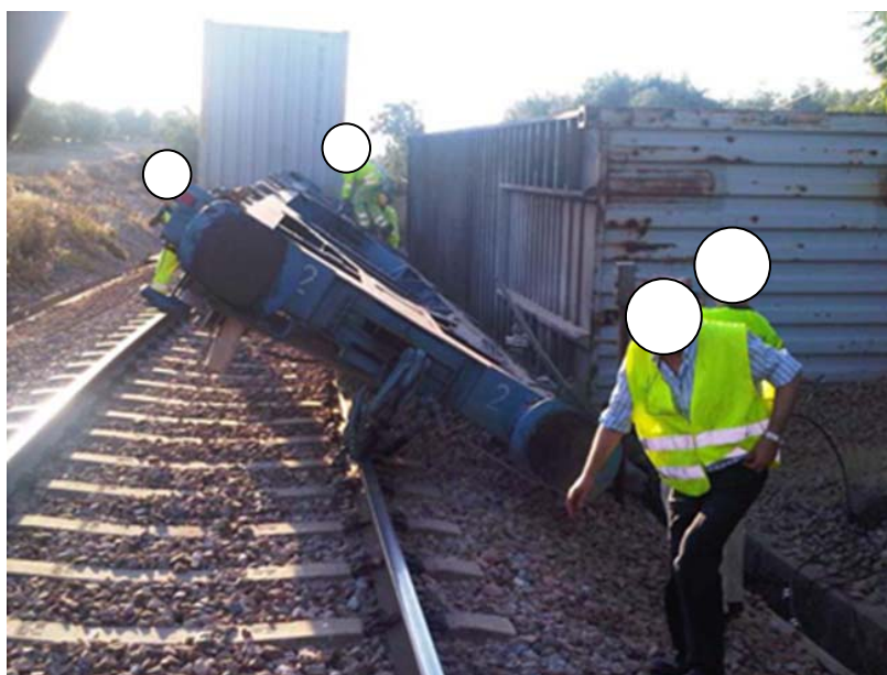
Plataforma descarrilada y contenedor caído (Fuente: Renfe Operadora)
