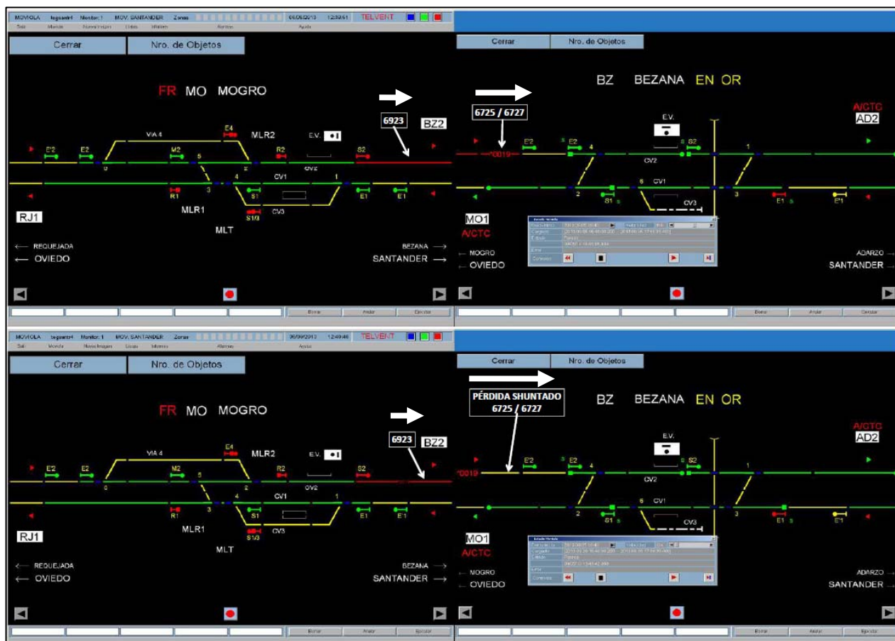
Detalle de la moviola del CTC de Santander, en el que se aprecia uno de los dos momentos en los que se produjo falta de shuntado en el circuito de vía ocupado por el tren 6725. (Fuente: Adif).
