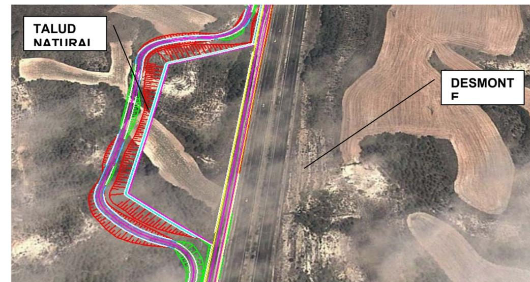
Imagen. Talud natural (zona área de servicio) y desmorte artificial (talud frente área de servicio)
