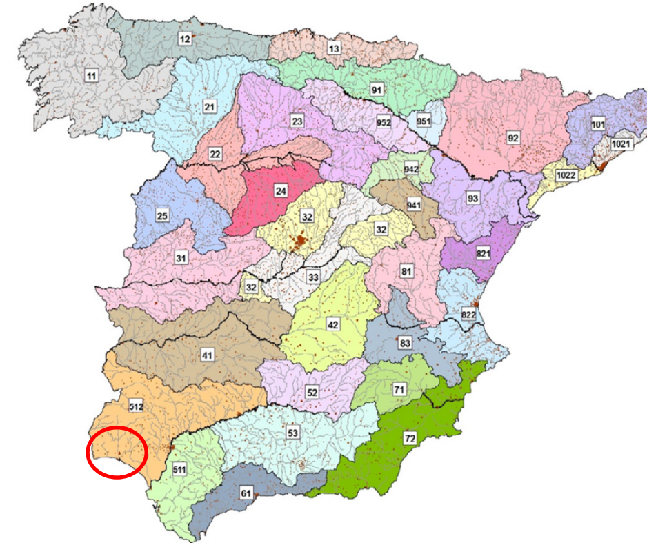
Figura 6. Regiones consideradas para la caracterización del coeficiente corrector del umbral de escorrentía s/ Norma 5.2-IC "Drenaje Superficial"
