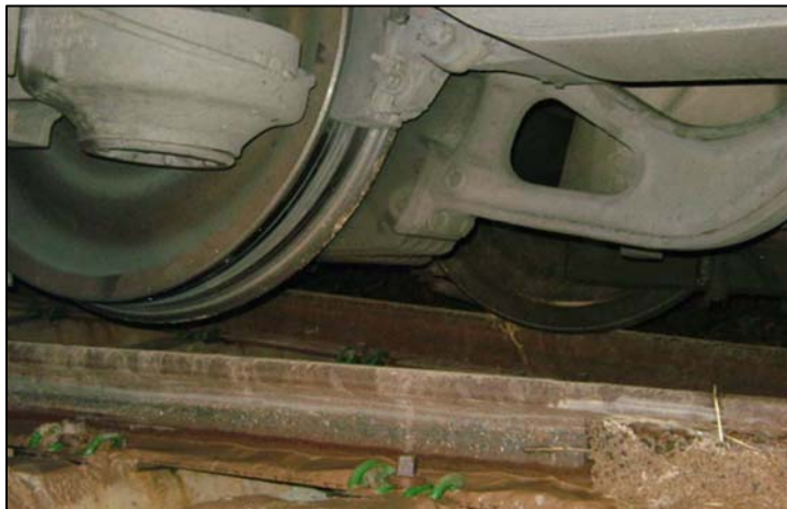
Perdida de contacto entre rueda y carril (Fuente: Renfe Operadora)
