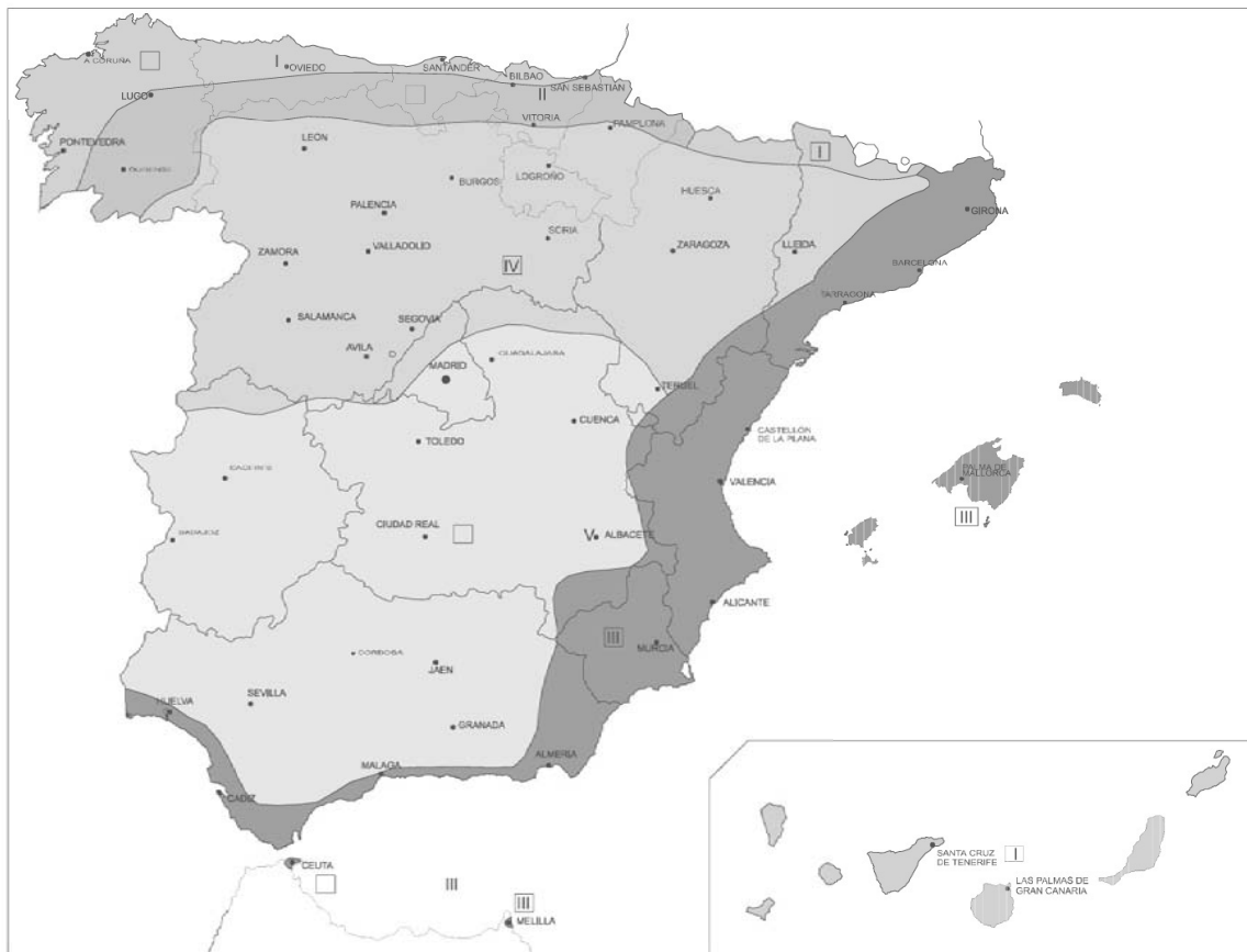
Figura 2.24: Mapa de zonas climáticas para la determinación de la variación uniforme anual de temperatura del tablero
